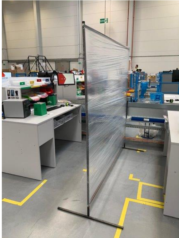
Barrière pour garantir la sécurité des collègues dans les espaces restreints
